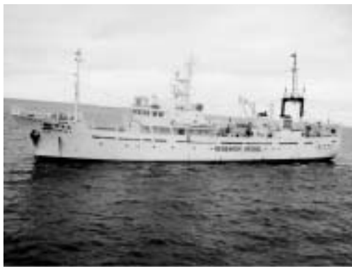
図6. 調査船「第七開洋丸」(499トン) 元は沖縄県の水産高校生の実習船であったものを海洋調査専門船に改造して使用している。トロールの他、様々な観測調査設備を有する。 (日本海洋㈱ 片岡真紀氏 提供)
