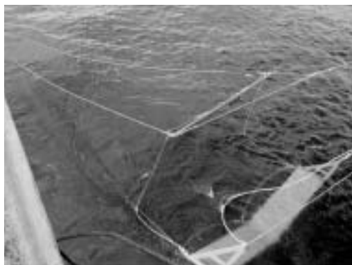
図4．IKMT（アイザックスキッド中層トロール網）船尾から曳網を開始した状態。餌生物調査では主としておきあみ等の採集を目的として使用している。 （日本海洋株式会社 片岡真紀氏 提供）
