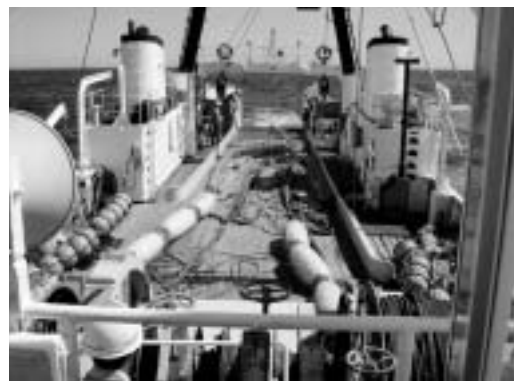
図2．トロール投網中（第三開洋丸） 表層曳網用にフロートを付けている状態。 （日本海洋株式会社 片岡真紀氏 提供）
