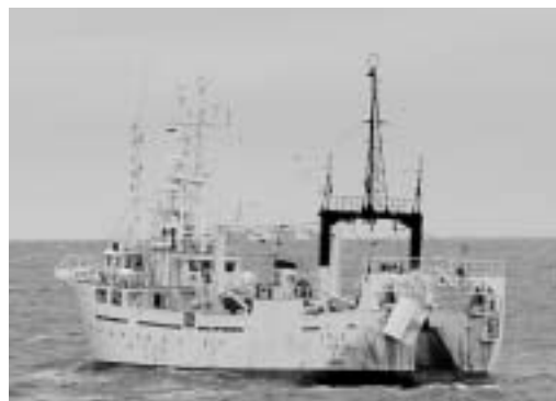
図5 . 調査船「とりしま」(426トン) 典型的な船尾トロール型漁業調査船である。
