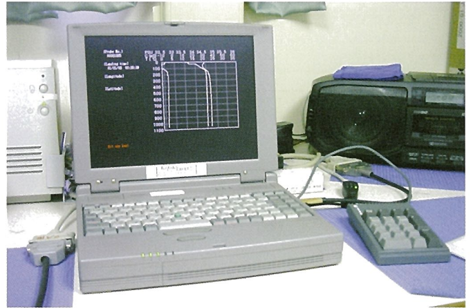
図 21. XCTD データ・モニター。海洋観測データは、船上で処理されます。
