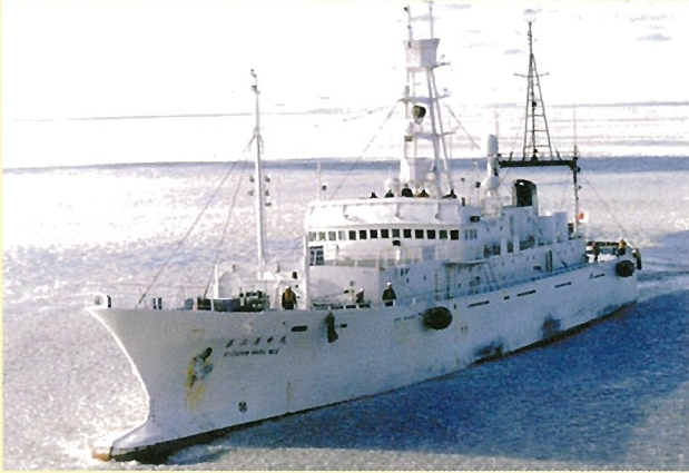
図12. 南極海の凍氷を縫ってゆく目視専門船、第2共新丸。目視調査のほか、計量魚探を用いたオキアミ資源の調査と海洋観測も実施します（全長68.18m、372トン）。
