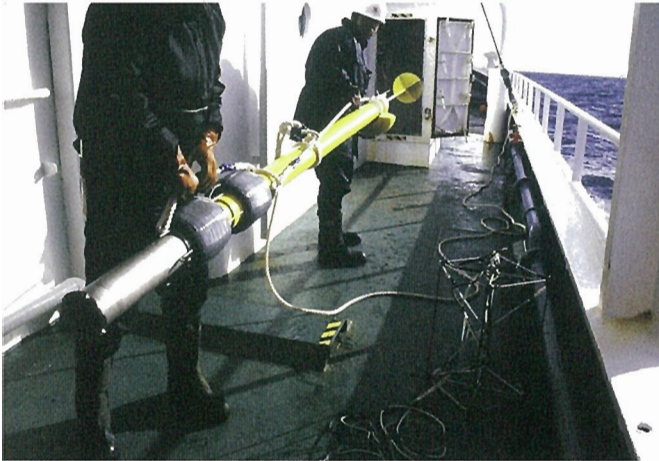
図82. 海に下ろすためにソノブイを準備しているところ（目視船第2共新丸にて）。
