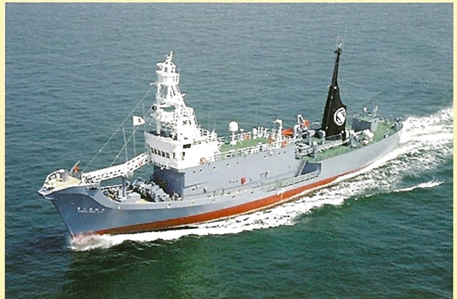
図15. 目視採集船、第2勇新丸。2002/03年以来調査船団に加わっています。目視採集船として機能するほか、海洋観測用機器も搭載されています（全長69.61m、747トン）。
